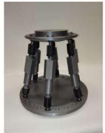
Prototipo di piattaforma di Stuart a 6 gradi di liberta' per uso medicale.
