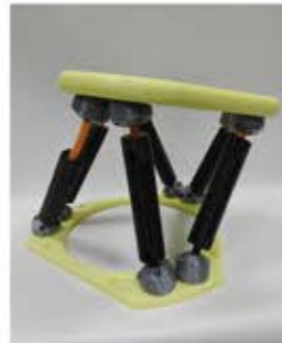
Prototipi di piattaforme di Stuart di differente architettura realizzate con Delta WASP 40 70.
