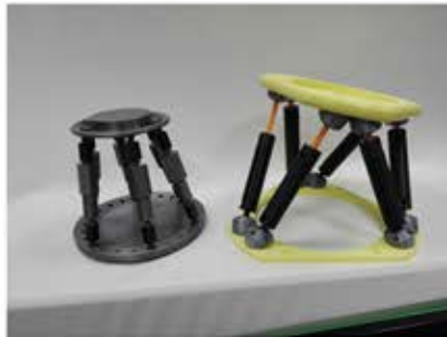
Prototipi di piattaforme di Stuart di differente architettura realizzate con Delta WASP 40 70.
